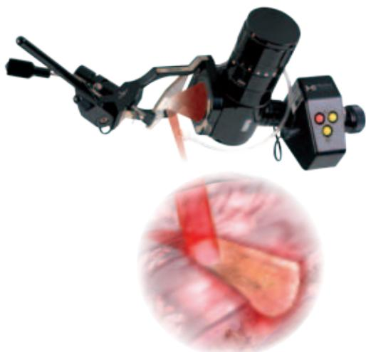
Sistema de escaneado HISCAN Surgical acoplado al micromanipulador EasySpot Hybrid.
